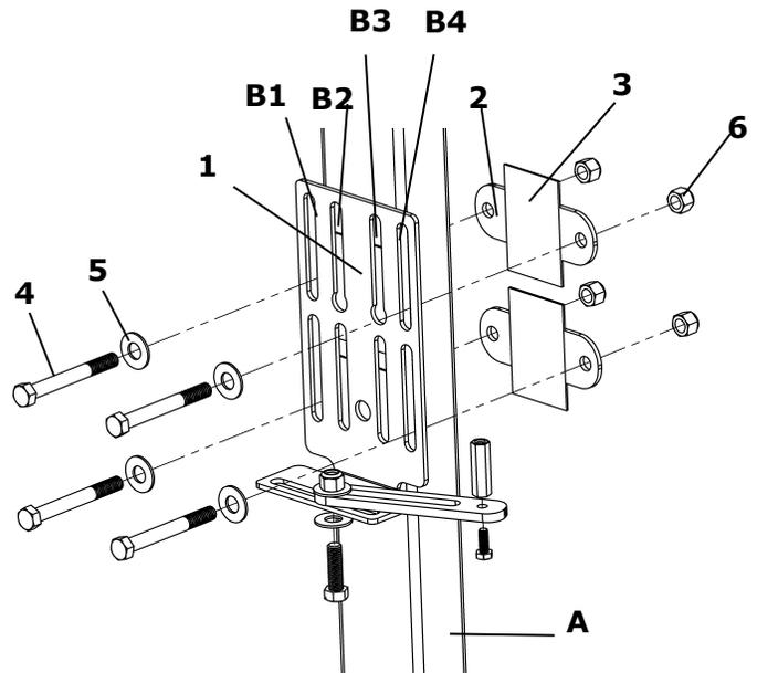
Installer le support arrière (item 1) sur la fixation de support arrière installé à l'étape précédente) à l'aide d'un boulon M10 X 30 (item 2), 2 rondelles 7/16"(item 3) et un écrou (item 4) tel qu'illustré
