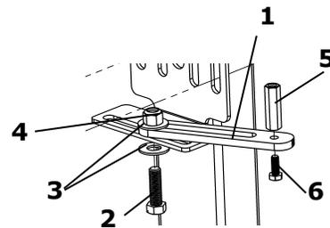
**NOTE :** s'assurer que l'écrou d'accouplement est perpendiculaire au sol. Si ce n'est pas le cas, il est possible de plier le support arrière, mais il est conseillé de faire ceci en dernier lorsque le positionnement de la cabine sera final
